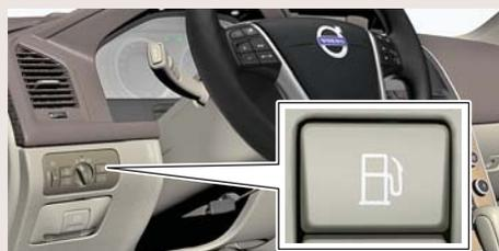
– Нажмите, чтобы открыть крышку топливного бака.
