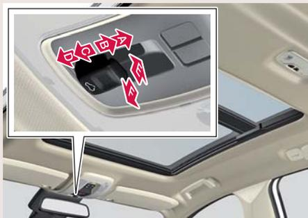
Первое нажатие на регулятор приводит в действие солнцезащитную шторку, а второе нажатие – панорамную крышу.
