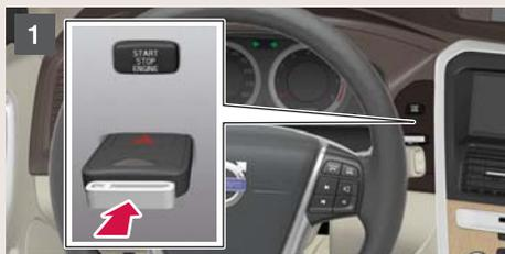
– Вставьте дистанционный ключ в замок зажигания и слегка нажмите – ключ втягивается в замок.
