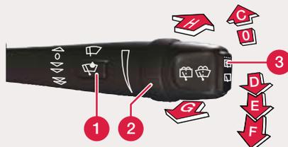
**1** Включение датчика дождя. В положении D-F датчик дождя отключается.
