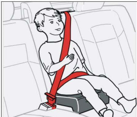
Встроенная фиксируемая ремнем подушка Volvo для внешних мест заднего сидения сконструирована в расчете на обеспечение оптимальной безопасности ребенка. Эта опорная подушка в комбинации со штатными ремнями безопасности рассчитана на детей весом от 15 до 36 кг.
