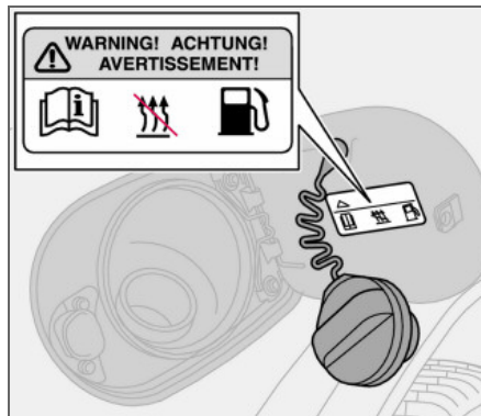
Предупреждающая наклейка на крышке топливного бака.
