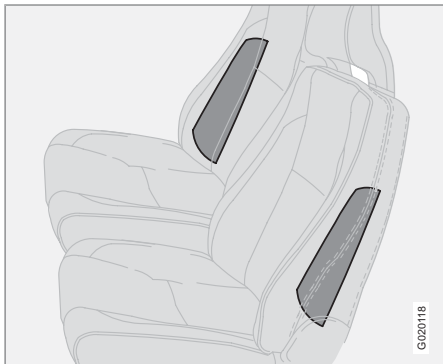
Расположение боковых подушек безопасности
