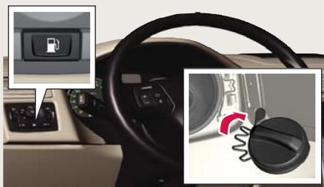
1. Нажмите, чтобы открыть крышку топливного бака.
