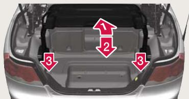
Перегорodka в багажнике разделяет багажное отделение, чтобы создать свободное пространство для складывания крыши.
