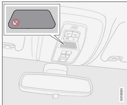
Индикация, указывающая на включенное положение подушки безопасности (SRS) на стороне пассажира.
