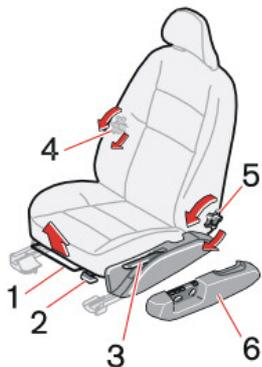
5. Регулировка наклона спинки сиденья, вращение рукоятки.
