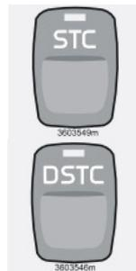
Данная клавиша используется для снижения или восстановления функций в системе STC/DSTC.
