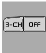
Для выбора трехканального стереозвучания нажмите на 3-CH. На дисплее показывается "3 ch". Нажмите на OFF для возврата к двухканальному стерео.
