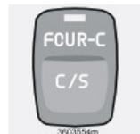
Нажмите на клавишу для выбора установки режима шасси Comfort или Sport, см. стр. 113. На информационном дисплее в течение 10 секунд показывается существующая установка.
