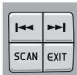
Нажмите кнопку SCAN, чтобы начать поиск. Когда радиоприемник находит станцию, он останавливается на ней в течение прим.
