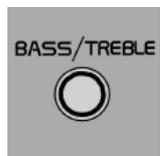
Для регулировки высоких частот выжмите ручку, вытяните ее дополнительно и вращайте влево и вправо. В среднем положении высокие частоты "нормальные".
