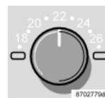
С помощью двух ручек можно устанавливать температуру на стороне пассажира и на стороне водителя. Помните, что обогрев или охлаждение салона не ускоряются, даже если выбрать более высокую или более низкую температуру, чем та, которую Вы желаете установить в салоне.
