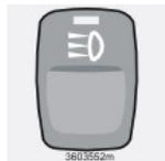
Используйте эту кнопку, если Вы хотите, чтобы дополнительное освещение автомобиля загоралось одновременно с дальним светом или если Вы хотите выключить эту систему. Светодиод в кнопке горит, когда система активирована.
