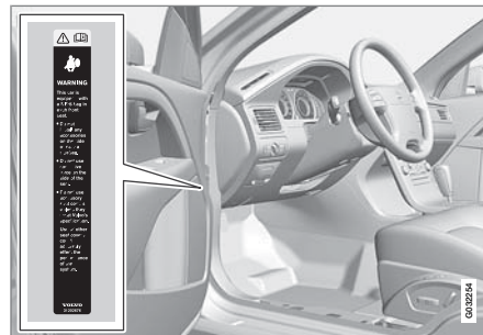
Табличка боковой подушки безопасности расположена на стойке двери.
