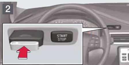
**Слегка нажмите на пульт.** При этом пульт дистанционного управления втягивается и устанавливается в нужном положении.
