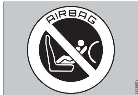
Предупреждающая табличка Airbag SRS расположена в торце панели приборов со стороны пассажира.
