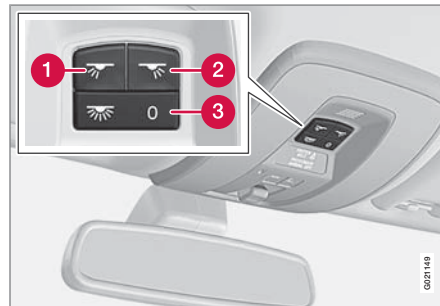
Клавиши управления в потолочной консоли передними лампами для чтения и освещением салона.
