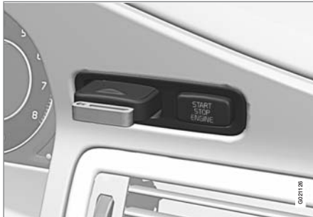
Замок зажигания с дистанционным ключом, кнопка пуска/останов.
