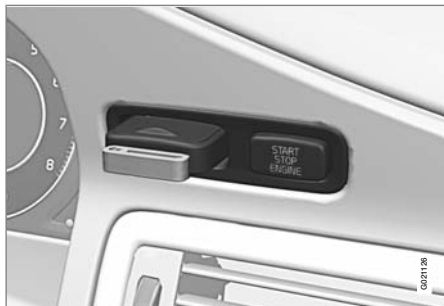
Замок зажигания с дистанционный ключом, кнопка пуска/останова Start/stop (подробно см. стр. 79).
