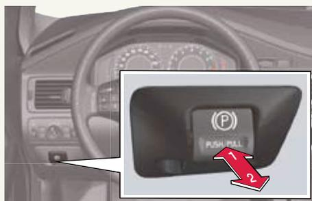
Включите передачу и трогайтесь с места. Стояночный тормоз отпускается автоматически.
