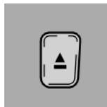
При нажатии на кнопку кассета останавливается и выбрасывается. Поверните ручку SOURCE для выбора другого источника. Кассету можно установить или извлечь, даже когда система выключена.
