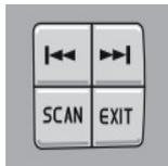
Для ускоренной прокрутки дорожки или всего диска нажмите и удерживайте левую или правую клавишу со стрелкой. Функция ускоренной прокрутки отсутствует на клавиатуре на рулевом колесе.
