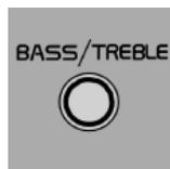
Для регулировки высоких частот выжмите ручку, вытяните ее дополнительно и вращайте влево и вправо. В среднем положении высокие частоты "нормальные".
