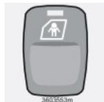
Используйте эту кнопку для активирования или отключения электронной блокировки для безопасности детей в задних дверях. Ключ зажигания должен быть в
