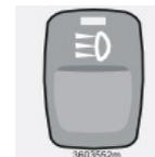
Используйте эту кнопку, если Вы хотите, чтобы дополнительное освещение автомобиля загоралось одновременно с дальним светом или если Вы хотите выключить эту систему. Светодиод в кнопке горит, когда система активирована.
