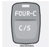
Нажмите на клавишу для выбора установки режима шасси Comfort или Sport, см. стр. 124. На информационном дисплее в течение 10 секунд показывается существующая установка.
