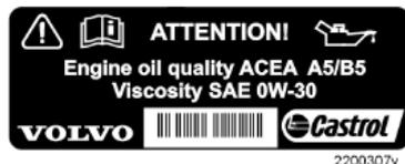
Если приведенная выше наклейка расположена в двигательном отсеке, имеет место следующее. Размещение см. на стр. 230.
