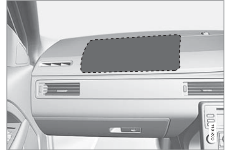
Расположение подушки безопасности на стороне пассажира в автомобиле с правосторонним управлением.
