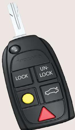
**LOCK** Запираются все двери, крышка топливного бака/дверь задка, а также активируется сигнализация\*.
