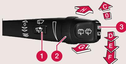
**1** **Активирование датчика дождя.** Лампа указывает, что датчик дождя включен. В положении **D–F** датчик дождя отключен.
