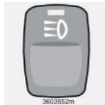
Пользуйтесь данной кнопкой, если Вы хотите, чтобы дополнительный свет загорелся одновременно с дальним светом фар или если Вы хотите выключить данную функцию. Светодиод в кнопке горит при активированной функции.
