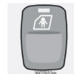
Используйте эту кнопку для активирования или отключения электронной блокировки для безопасности детей в задних дверях. Ключ зажигания должен быть в положении **I** или **II**. Когда
