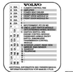
Наклейка с указанием позиции предохранителей и числа ампер расположена под крышкой торцевого блока.
