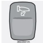
Эта кнопка используется для складывания или раскладывания внешних зеркал заднего вида.
