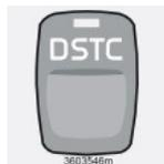
Данная кнопка используется для снижения или восстановления функций системы DSTC. Если светодиод в кнопке горит, система DSTC активирована (при условии отсутствия
