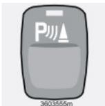
При запуске двигателя система всегда активирована. Нажмите кнопку для отключения/восстановления системы предупреждающей о движении задним ходом. См. также стр. 125.
